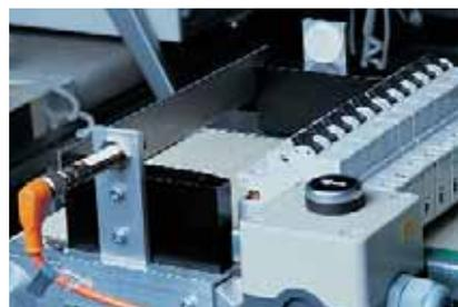
Рефлектор отражает луч света. В рефлекторных датчиках излучатель и приемник находятся в одном корпусе.
